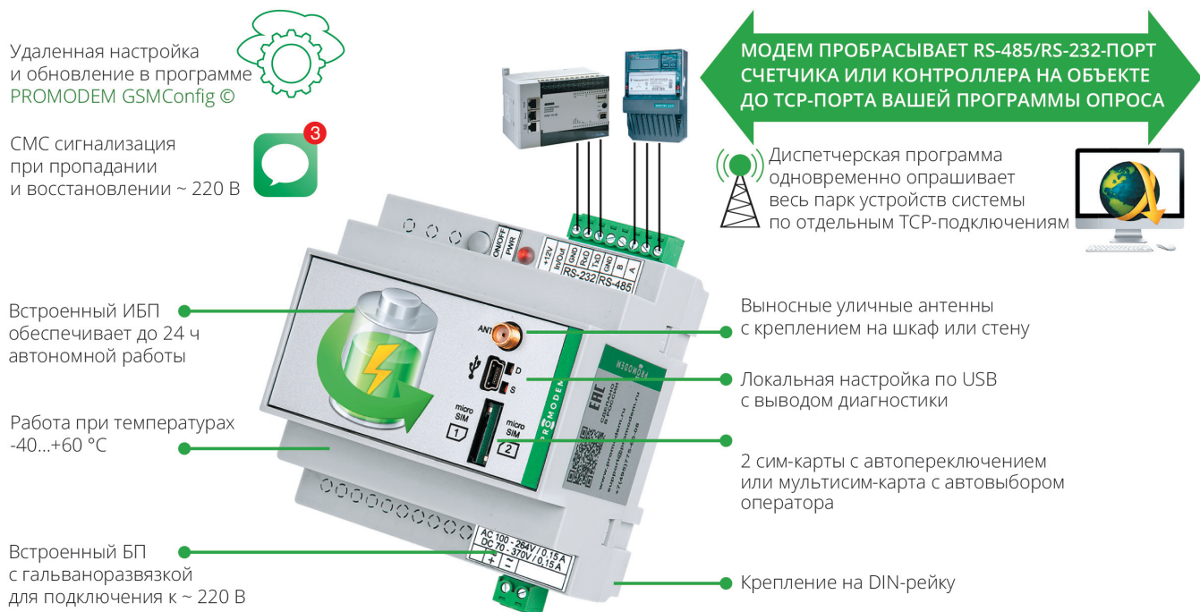
Рис. 3. Промышленный модем PROMODEM GSM-125.89M с двумя независимыми портами RS-485 + RS-232 для подключения оборудования разного типа и встроенным ИБП на несколько часов автономной работы; температура эксплуатации – от -40 до +60 °C, крепление на DIN-рейку
