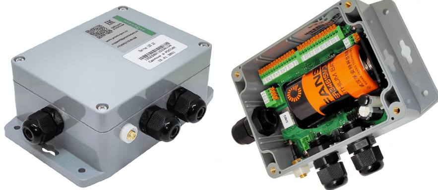
Рис. 6. Автономный промышленный модем PROMODEM GSM-125.00М с двумя портами RS-485 + RS-232 для подключения оборудования разного типа, степень защиты IP65 и батарей на несколько лет автономной работы; температура эксплуатации – от –40 до +70 °С
